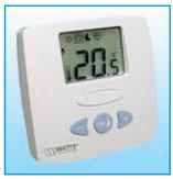
Термостат может работать как по встроенному температурному датчику, так и по выносному датчику (датчик температуры пола с настраиваемым ограничителем температуры в пределах 10...40 °С и кабелем длиной 3 м, не входит в комплект), либо по встроенному и выносному датчикам.
